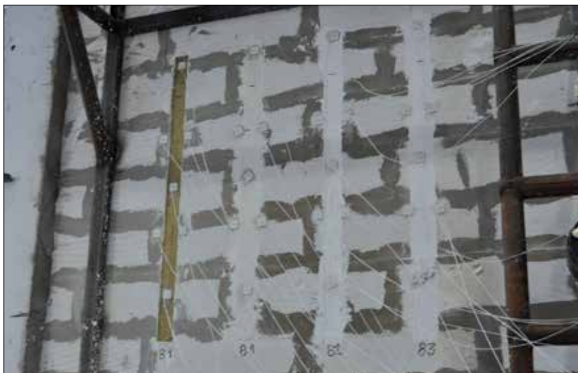
◀ Fot. 3. Widok nienagrzewanej powierzchni elementu próbnego w trakcie badania w zakresie odporności ogniowej (uszczelnienia złączy liniowych w ścianie)
