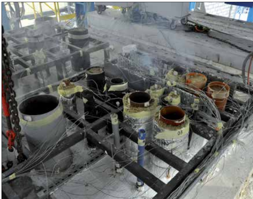
▲ Fot. 2. Widok nienagrzewanej powierzchni elementu próbnego w trakcie badania w zakresie odporności ogniowej (mieszane uszczelnienie przejścia w stropie)
