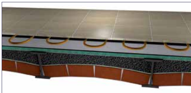
Fot. 4. ► Strop odcinkowy z dodatkowym ogrzewaniem elektrycznym
