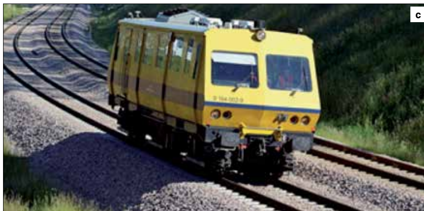
▲ Fot. 1. Przyrządy i urządzenia pomiarowe do badań diagnostycznych stanu geometrycznego toru:
