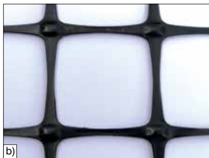
▲ Fot. 3. Przykłady geosiatek: a) tkaną, b) o sztywnych węzłach
