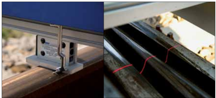
Fot. 2. ► Profilomierz X-Y do torów i rozjazdów – do- tykowy i bezdotkowy (optyczny za pomocą czujnika laserowego) sposób odwzorowania kształtu profilu zużytego w wybranym przekroju kontrolnym [8]
