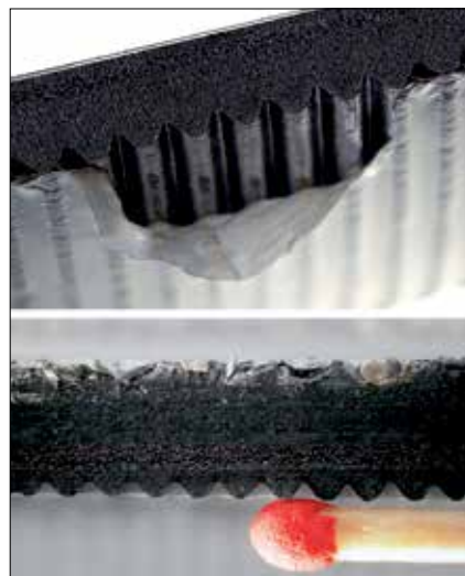
Papy Icopal w Systemie Szybki Profil SBS – mikroskopowe powiększenie poprzecznego przekroju papy
