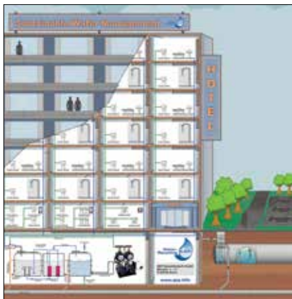
System przetwarzania i wykorzystania wody szarej
