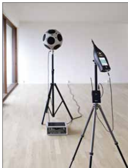
Przykład systemu akustyki pomieszczeń: analizator 2250/2270 ze wzorcowym źródłem dźwięku 4292-L i wzmacniaczem mocy 2734
