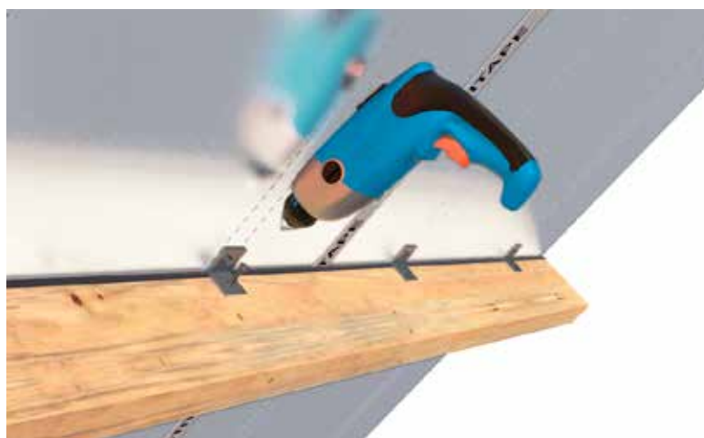
Rysunek 8: mocowanie od wewnątrz z profilem kątowym
