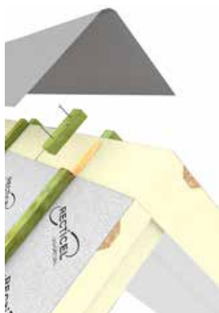
Rysunek 16 i 17: wykończenie kalenicy na zakład
