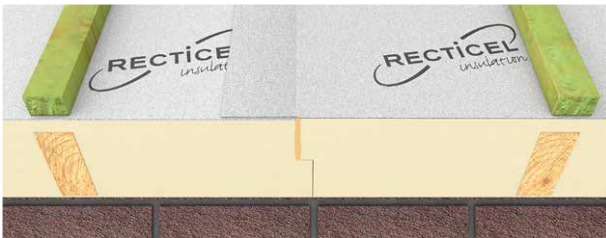
Rysunek 14: podłużna fuga wypełniona zostaje niskorozprężną, elastyczną pianą PU i kolejno przykryta zakładem zaintegrowanej folii dachowej
