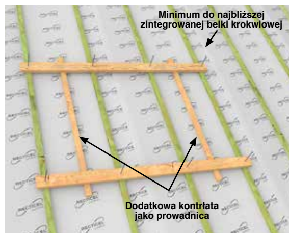
Rysunek 9: przygotowanie do wykonania otworu na okno dachowe
