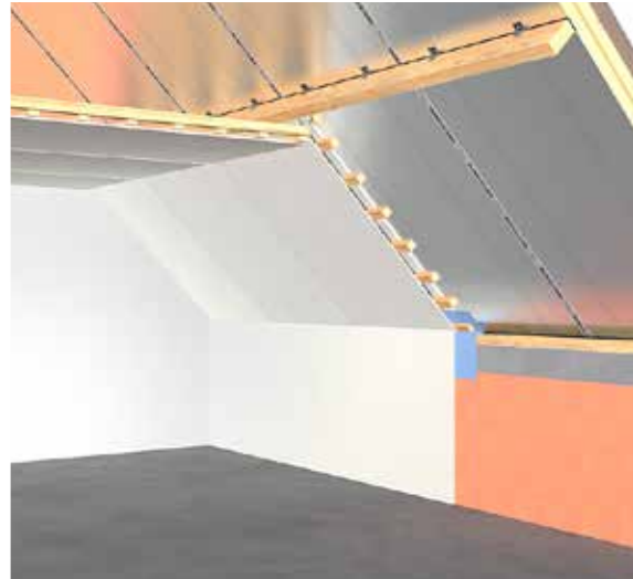
Rysunek 22: przykład wykończenia od wewnątrz z uwzględnieniem przestrzeni na okablowanie
