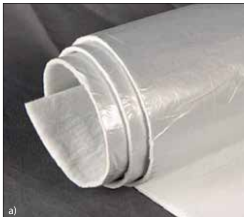
Fot. 6. Przykładowy asortyment i zastosowanie porogelu: a) pojedyncza mata porogelu [11], b) mata z porogelu podczas montażu [14]
