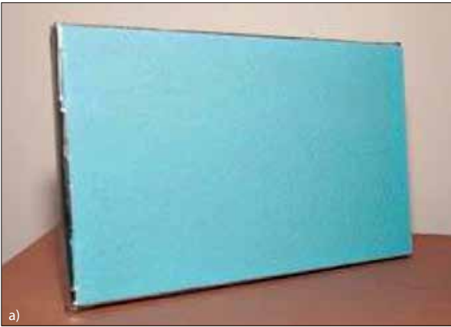
Fot. 7. Przykładowy asortyment płyt próżniowych VIP: a) pojedyncza mata VIP [15], b) asortyment płyt VIP[11]
