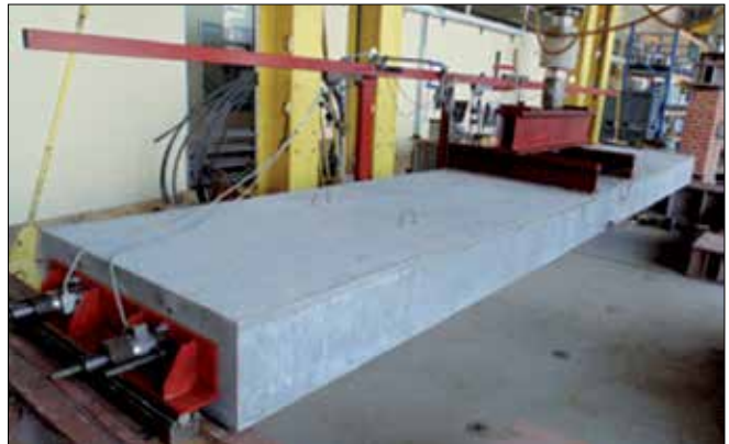
Fot. 3. Produkcja kablobetonowego elementu prefabrykowanego [5]
