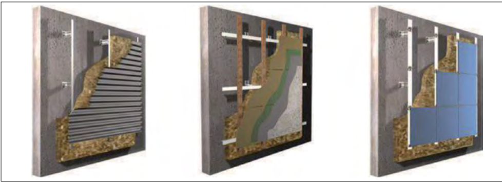
Rys. 1. Przykładowe rozwiązania fasad wentylowanych – technologia lekka-sucha [4]
