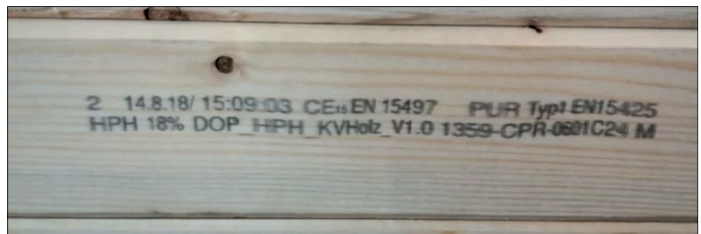
Fot. 2. Przykład znakowania elementu klejonego z drewna C24
