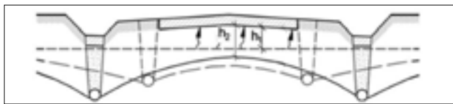
Rys. 9. Obniżenie zwierciadła wody gruntowej do drogi
