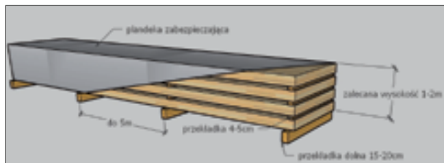
Rys. 9. Zalecenia składowania na placu budowy (plandeki nie mogą dotykać ziemi)
