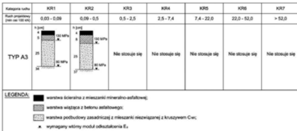
Rys. 6. Typowe rozwiązania górnych warstw nawierzchni – typ A3
