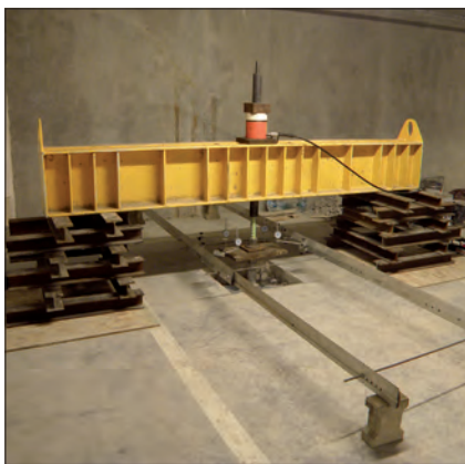
Próbne obciążenie mikropala kotwiącego, Wrocław
