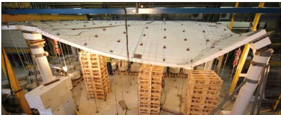
Badanie płyty zbrojonej stalą EPSTAL w sytuacji katastrofy postępującej, prowadzone na Politechnice Śląskiej
