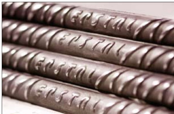
Napis EPSTAL nawalcowany na prętach
