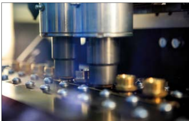
Montaż zaworów regulacyjnych rozdzielaczy do ogrzewania i chłodzenia płaszczyznowego
