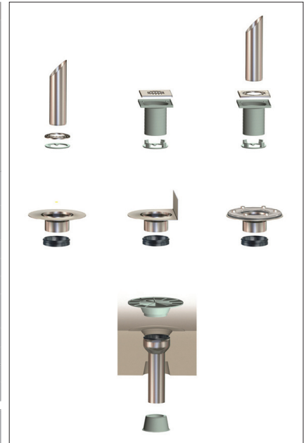
Schemat konfiguracji systemu odpływów balkonowych LORO
